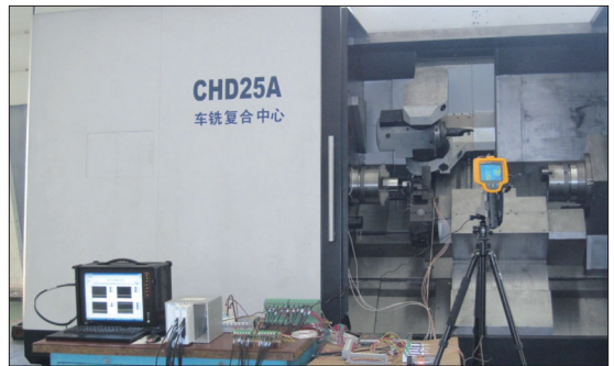
数控机床动态特性在线测试
