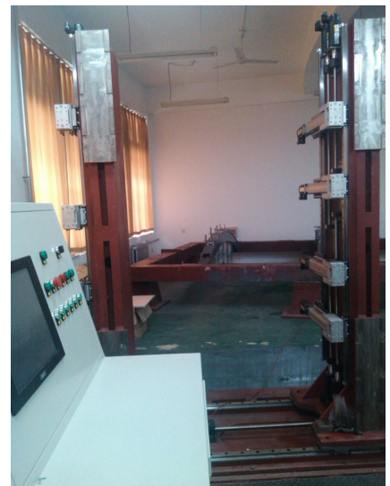
图4 壁板组件柔性工装安装现场
