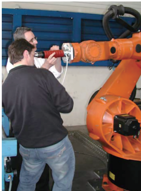
图2 Integrity TestLab公司研制的机械手臂数控超声喷丸成形设备
