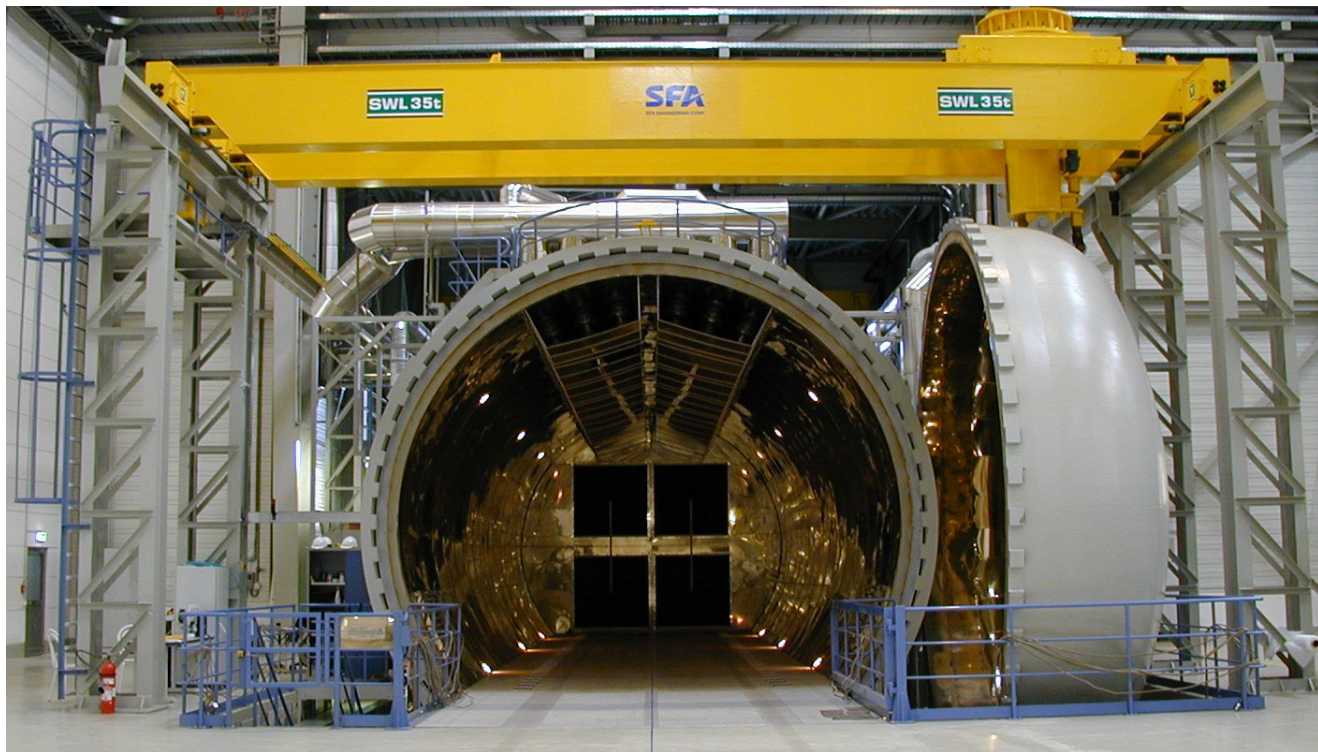
图4 韩国SFA公司7m×21m热压罐系统（用于A350机身舱段零件生产）
