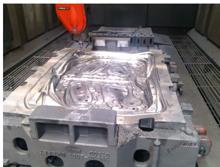
图2 模具数控参数化编程的应用流程及现场加工图
