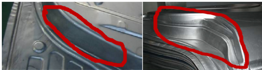
图8 车门类覆盖件模具陡壁容易让刀欠加工位置
