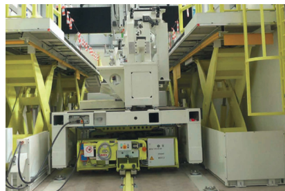
图5 五轴机加站位中的可移动工装
