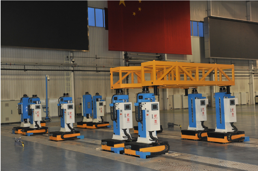
图3 大部件自动对接柔性装配平台
