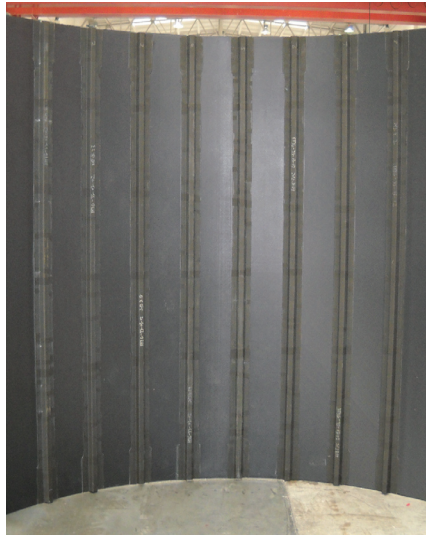
(b) 机身帽型加筋壁板(投影尺寸 2.5m × 2.3m)
