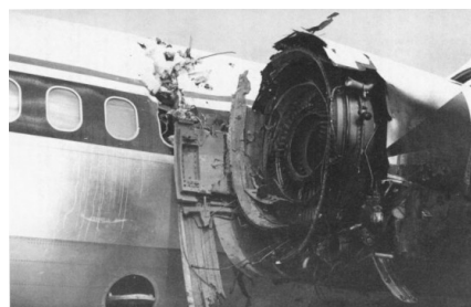
图1 风扇叶片断裂导致风扇机匣和飞机机体损坏
