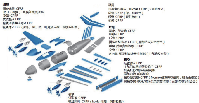
图1 A400M的复合材料结构分布
