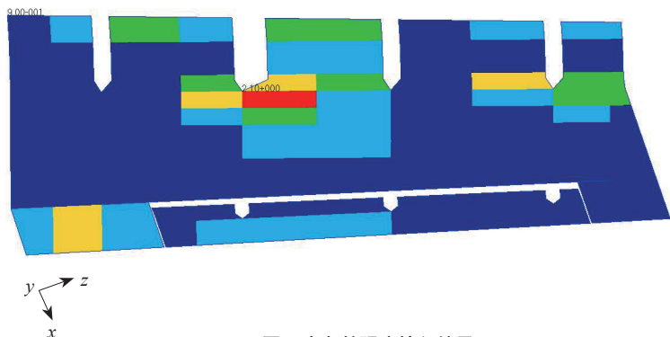
图2 方向舵强度输入结果
