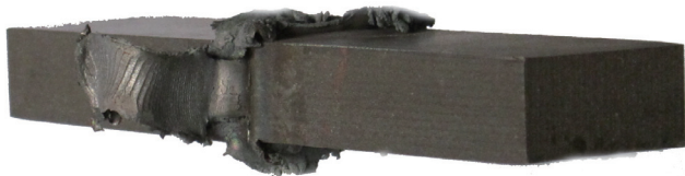
图4 TA2 纯钛试件焊后外观
