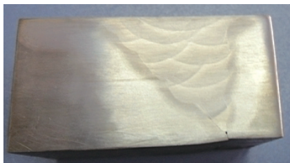
图8 平焊接头的宏观金相
