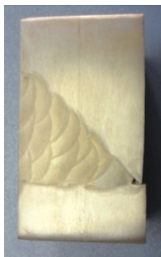
图9 横焊接头的宏观金相
