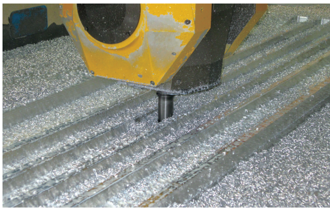
图3 铝合金整体壁板的加工
