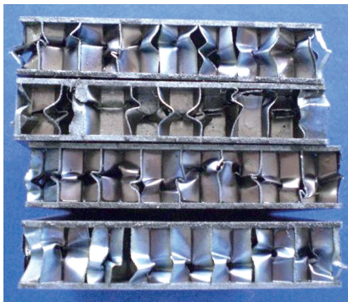
图3 平压缩试验件 Fig.3 Compression test specimen
