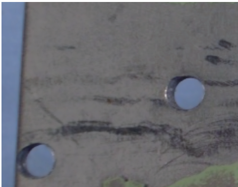
图14 铆钉孔壁存在飞边
