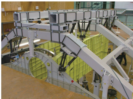
图3 盒式连接工装系统在“神经元”无人机机身段装配中的应用示范
