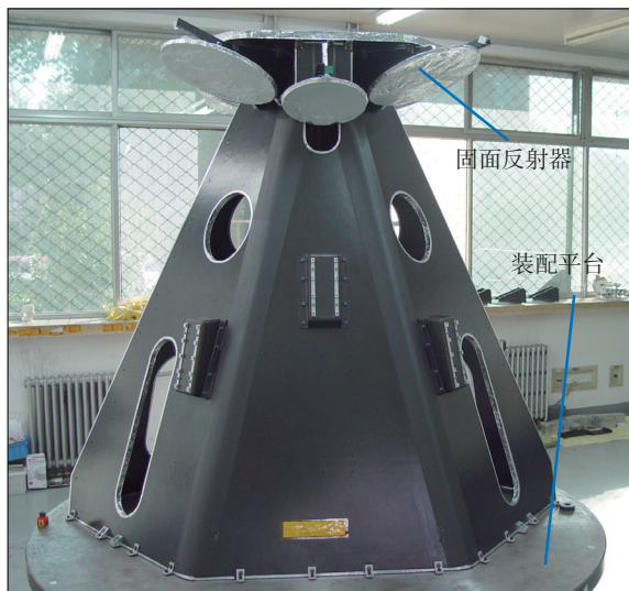
图1 典型卫星固面天线装配形式
