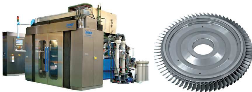
图3 MTU多轴精密振动电解加工设备及EJ200压气机高温合金整体叶盘
