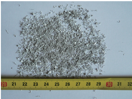
图15 螺旋轨迹制孔产生的切屑
