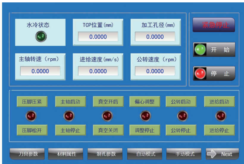
图11 螺旋轨迹制孔控制操作界面
