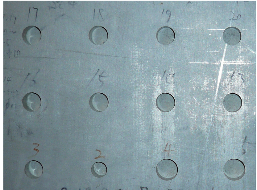
图14 钛合金TC4制孔结果
