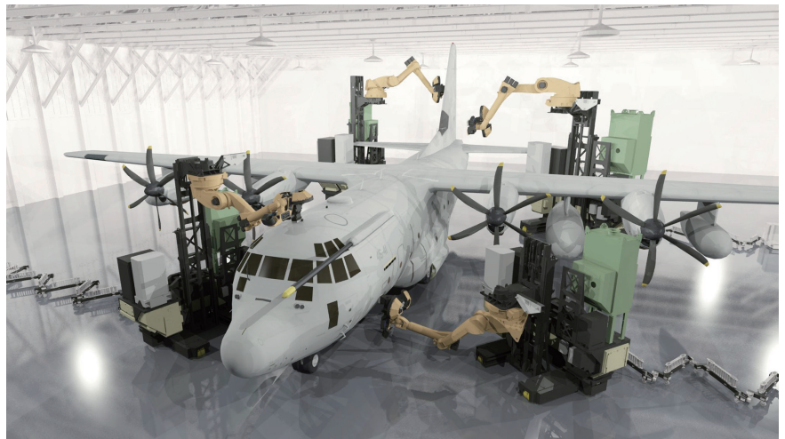
图3 采用移动式工业机器人进行飞机涂层
