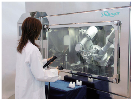
(a) 日本涩谷 Hoppmann 公司开发的遥操作式化工品隔离制备设备
