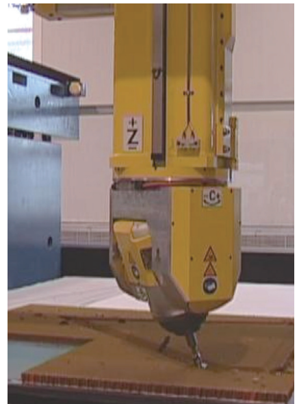
图2 NOMEX蜂窝构件数控超声加工应用实例
