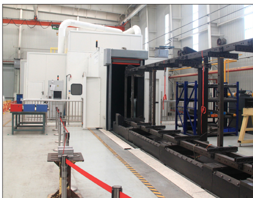
图6 西飞公司喷丸成形设备
