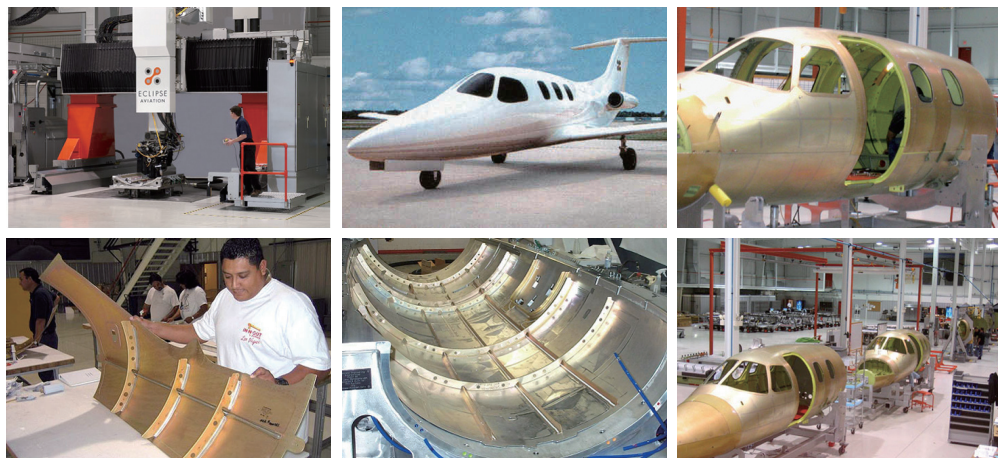
图5 搅拌摩擦焊接应用于N500商务飞机
