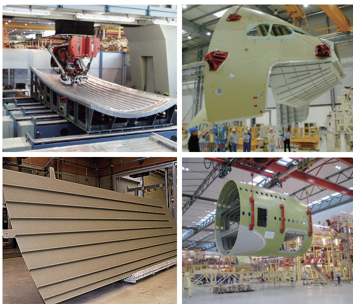
图4 空中客车公司A380激光焊接机身壁板结构件
