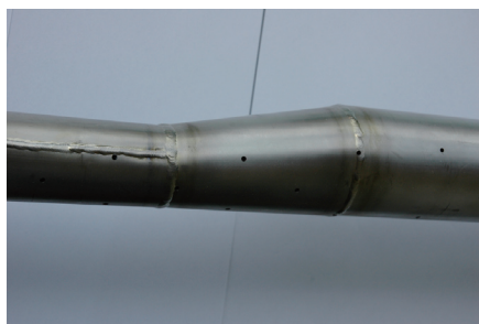
图1 TB5钛合金焊管
