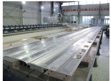
图11 搅拌摩擦焊接的地板
