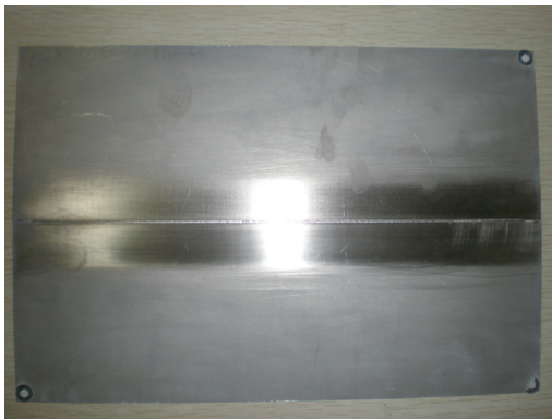
图9 激光焊接钛合金试件焊缝
