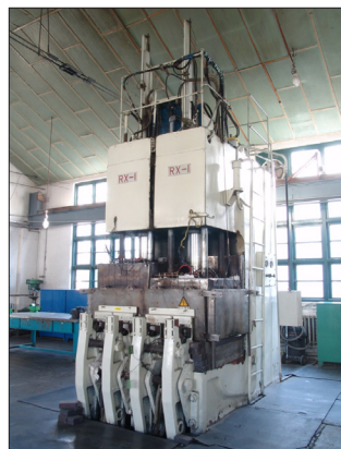
(a) 带测压系统的国产开式热压机
