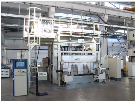
(b) 中外合作研制的闭式热压机
