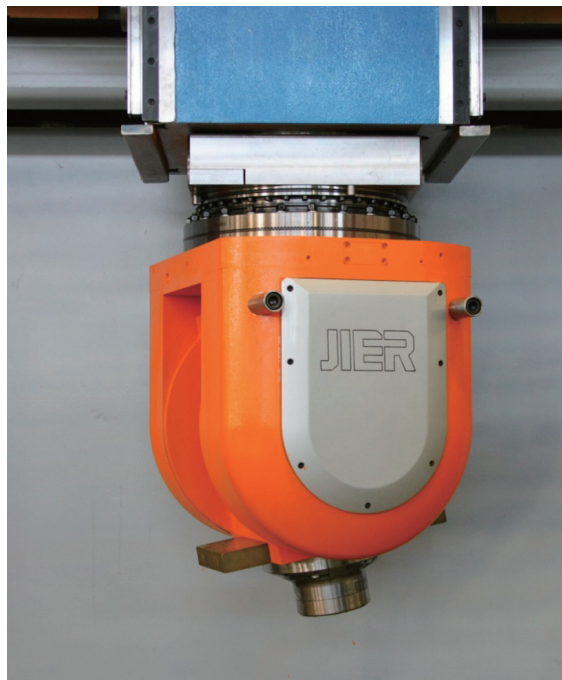
图5 电主轴式力矩电机驱动A/C双摆角数控万能铣头
