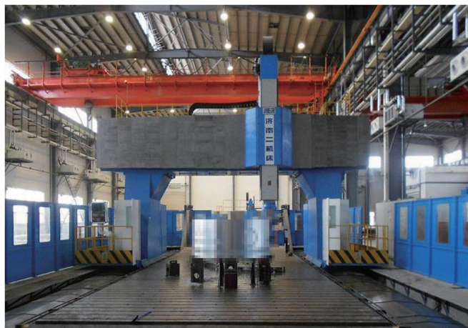
图7 为航天行业提供的高速龙门五轴加工中心
