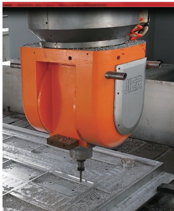
图5 电主轴式力矩电机驱动A/C双摆角数控万能铣头
