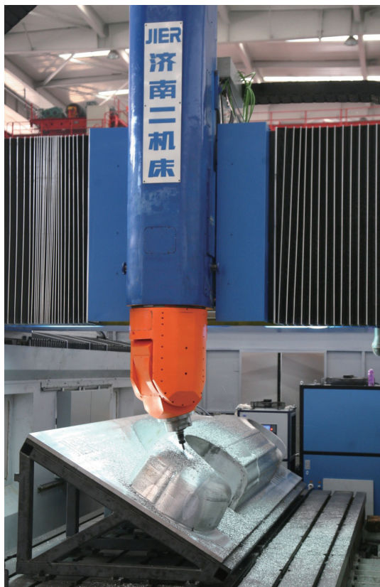
图4 电主轴式机械驱动A/C双摆角数控万能铣头
