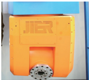
图6 机械主轴式A/C双摆角数控万能铣头
