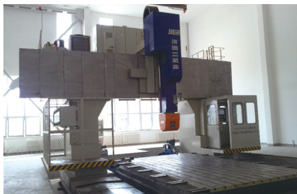
图3 为中航工业某研究所提供的 XHV2730 × 60五轴联动高速镗铣加工中心率、大扭矩重型双龙门移动机械式五轴联动数控龙门镗铣床,成功交付鞍钢重型机械公司,加工三峡大型水电机组叶片,打破了国外企业在水利水电等重点行业的垄断地位。
