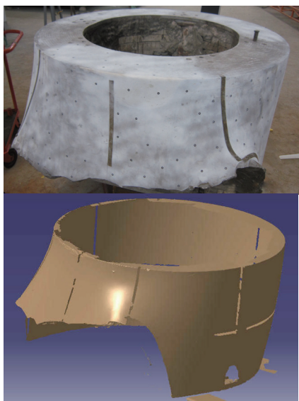
图8 在软件中得到的点云与实物对比示意图
