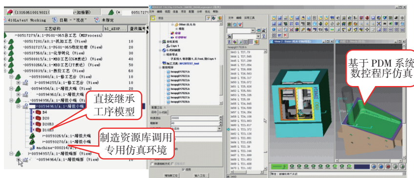
图3 基于PDM系统平台数控程序仿真
