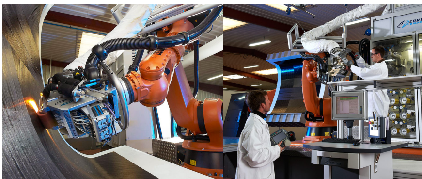
图3 法国科里奥利的机器人铺放机
