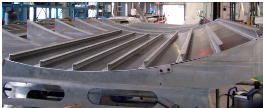
图4 喷丸成形的焊接带筋整体壁板模似件
