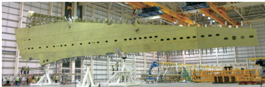
图2 空客A380飞机及其喷丸成形外形翼下翼面整体壁板
