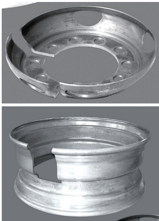
图4 旋压工艺制造的等强度轮辋和轮辐
