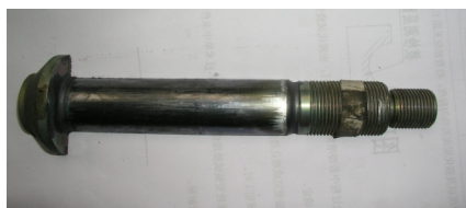
图3 减摩安装的损伤
