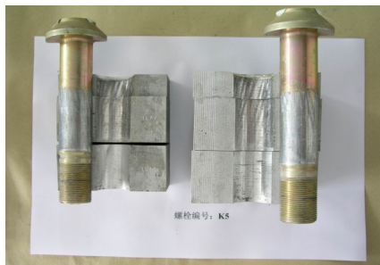
图2 直接强迫安装的损伤
