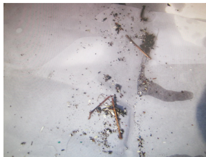
图2 飞机油箱中清洗出来的杂质
