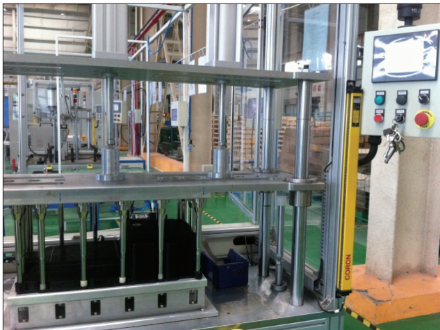
图3 气密性现场检测
