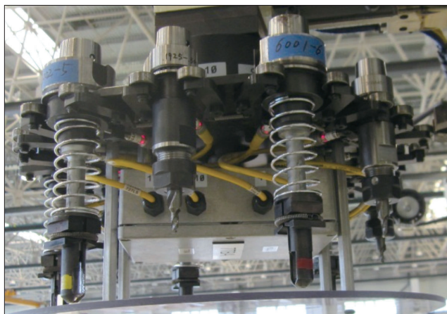
图5 末端执行器上的刀库 Fig.5 Tool base on the end effector
