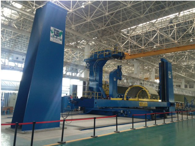
图2 以液压为动力的自动钻铆系统
