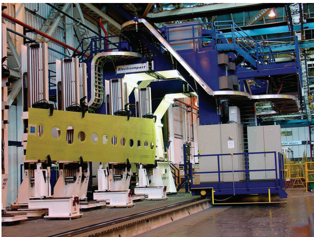
图3 以电磁铆接为动力的自动钻铆系统
