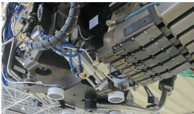
图6 末端执行器上的多个射钉装置 Fig.6 Injectors on the end effector
