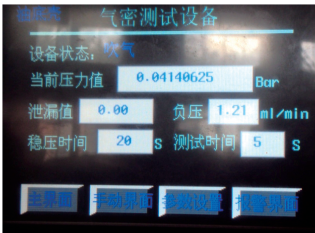
图4 气密性检测结果显示
