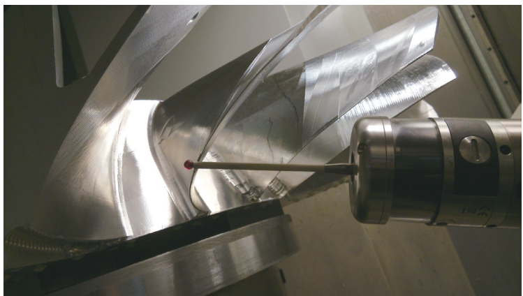
图4 利用测杆对进排气边进行测量
