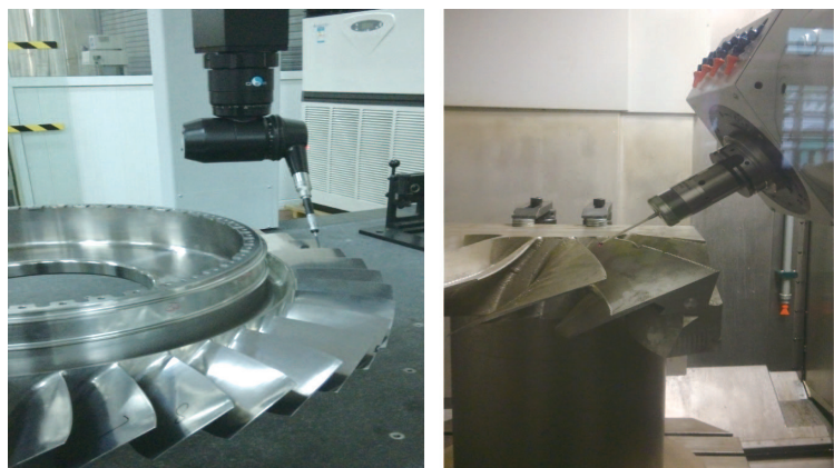
图3 测量机测量(左)与在线测量(右)
