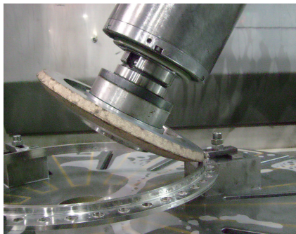
图4 CBN砂轮超高速高效磨削涡轮盘环
