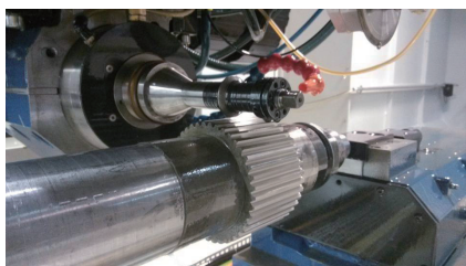
图2 CBN砂轮成型磨削高温合金轴花键
