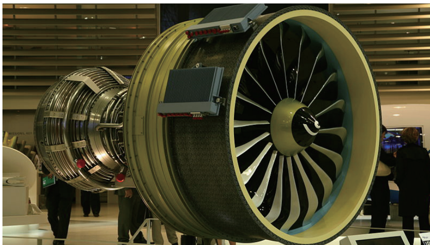
图1 Leap-X发动机发动机风扇叶片及其机匣采用CFRP复合材料
