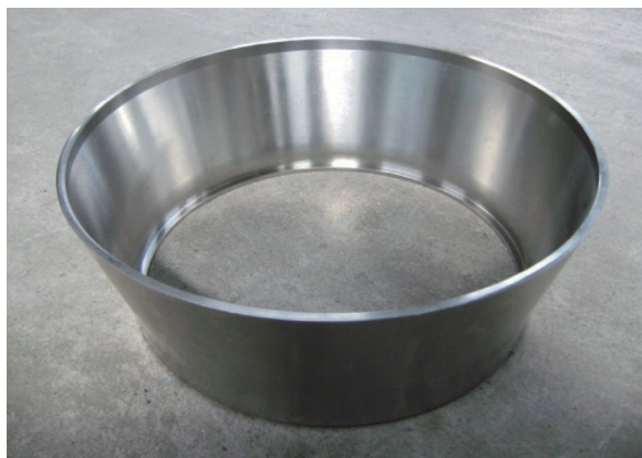
图4 旋压成形高温合金发动机机匣
