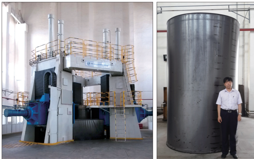
图6 1000kN大型立式数控旋压机及其加工的零件
