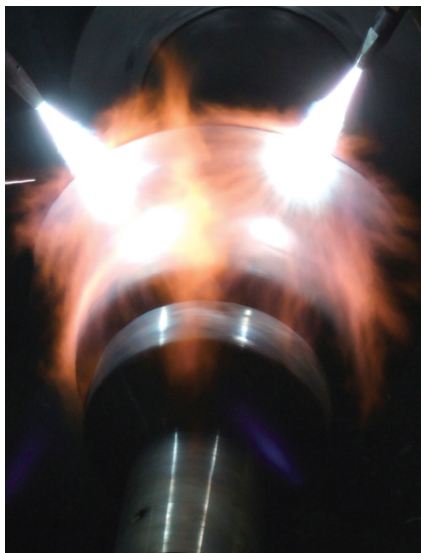
图3 钛合金加热旋压成形过程
