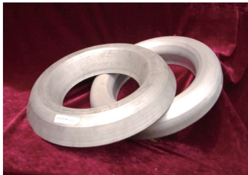
(b) 旋压成形的飞机发动机唇口
