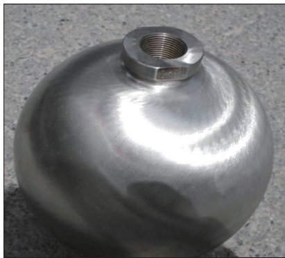
(a) 旋压成形的套筒、球形气瓶
