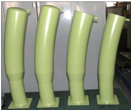
(a) 旋压成形的套筒、球形气瓶
