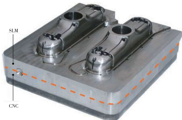
图5 采用SLM和数控技术制造的注塑模具型腔镶块
