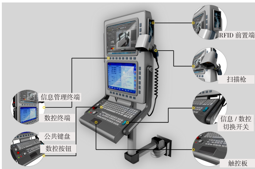
图2 一体化终端设备
