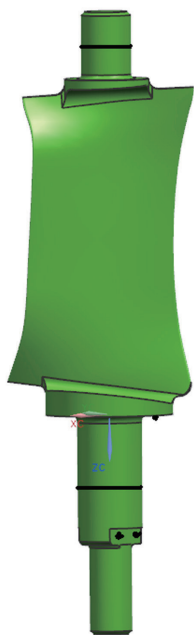
图7 建立轴颈式 (PIPS) 叶片坐标系
