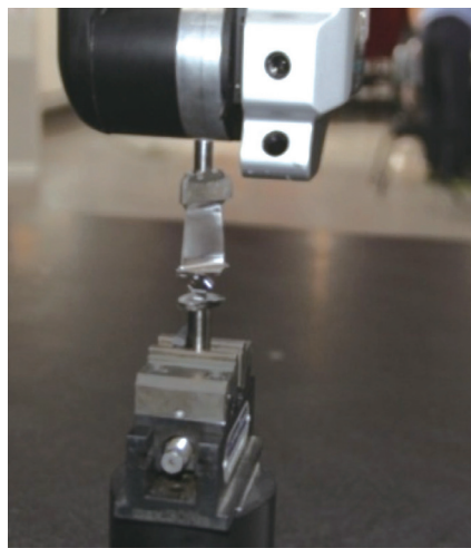
图4 叶片装夹方法
