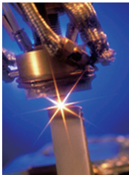
图6 激光熔敷加工3D打印的工艺模式
