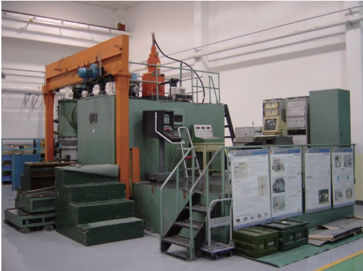
图1 ZD150-15A型高压电子束焊接设备
