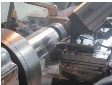
图1 气雾微量润滑辅助PCD刀具切削钛合金装置
