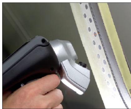
图2 激光枪测量铆钉平面差图
