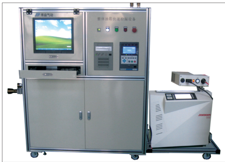
图8 整体油箱快速检漏设备组成图
