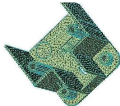
图5 划分网格后的模型
